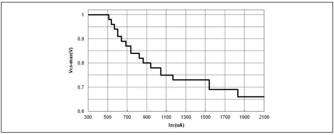
Figure 8 V<sub>CS\_max</sub> versus I<sub>ZC</sub>
