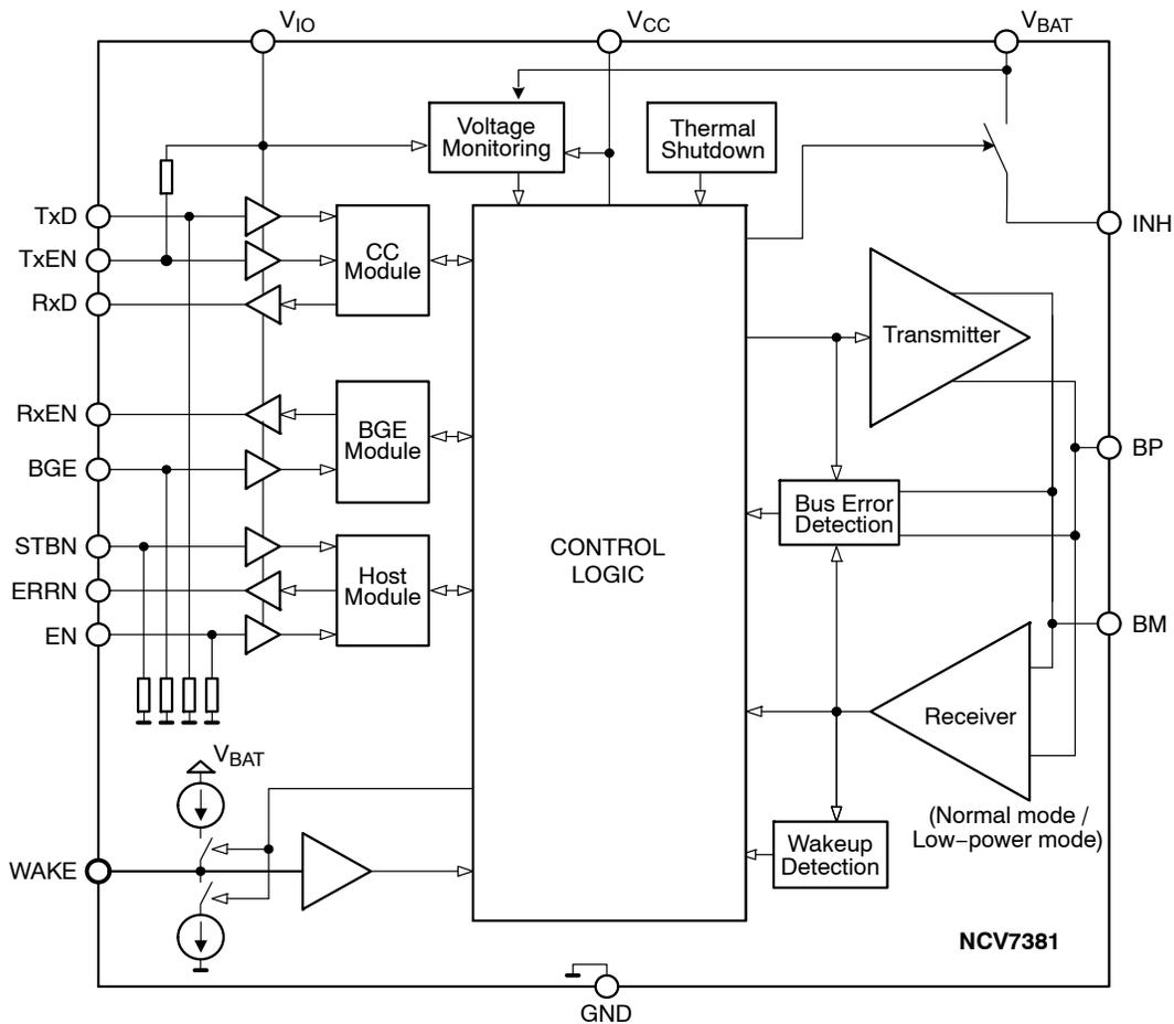
**Figure 1. Block Diagram**
