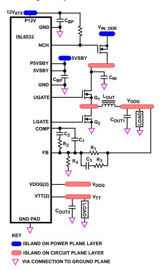
FIGURE 4. PRINTED CIRCUIT BOARD POWER PLANES
