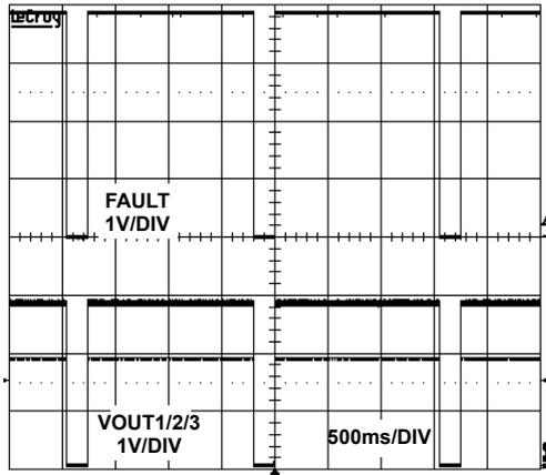
FIGURE 9. THERMAL SHUTDOWN OPERATION
