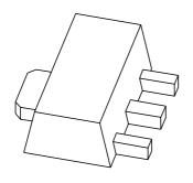
PBSS4520X 20 V, 5 A NPN low V<sub>CEsat</sub> (BISS) transistor
